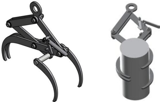
Auch bei den formschlüssigen Greifern ist ein Oberflächenschutz der Last möglich. Die Greifbereiche können mit PU-Schutz ausgestattet werden. I.d.R. ist dieser nach Verschleiß austauschbar ausgelegt.
