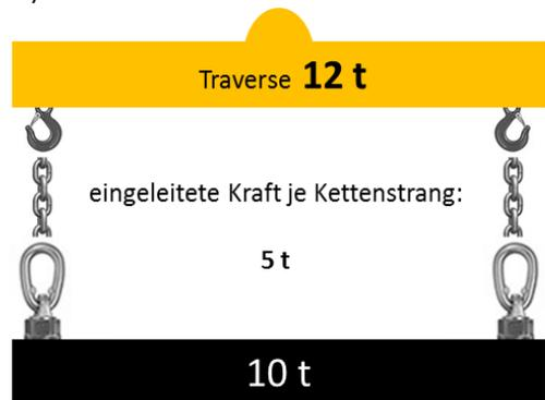
Durch den Einsatz von Traversen reduziert sich die eingeleitete Kraft in den Kettensträngen. Bei einem Neigungswinkel von 0° verteilt sich die Last pro Kettenstrang auf 50% der gesamten Last. WEWIRA bietet ein umfangreiches Programm und auch Sonderlösungen im Bereich der Lastaufnahmemittel/ Traversen. Gerne beraten wir Sie hier zu der geeigneten Lösung und konzipieren gemeinsam mit Ihnen die richtige Traverse.
