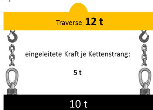
Durch den Einsatz von Traversen reduziert sich die eingeleitete Kraft in den Kettensträngen. Bei einem Neigungswinkel von  $0^\circ$  verteilt sich die Last pro Kettenstrang auf 50% der gesamten Last. WEWIRA bietet ein umfangreiches Programm und auch Sonderlösungen im Bereich der Lastaufnahmemittel/ Traversen. Gerne beraten wir Sie hier zu der geeigneten Lösung und konzipieren gemeinsam mit Ihnen die richtige Traverse.
