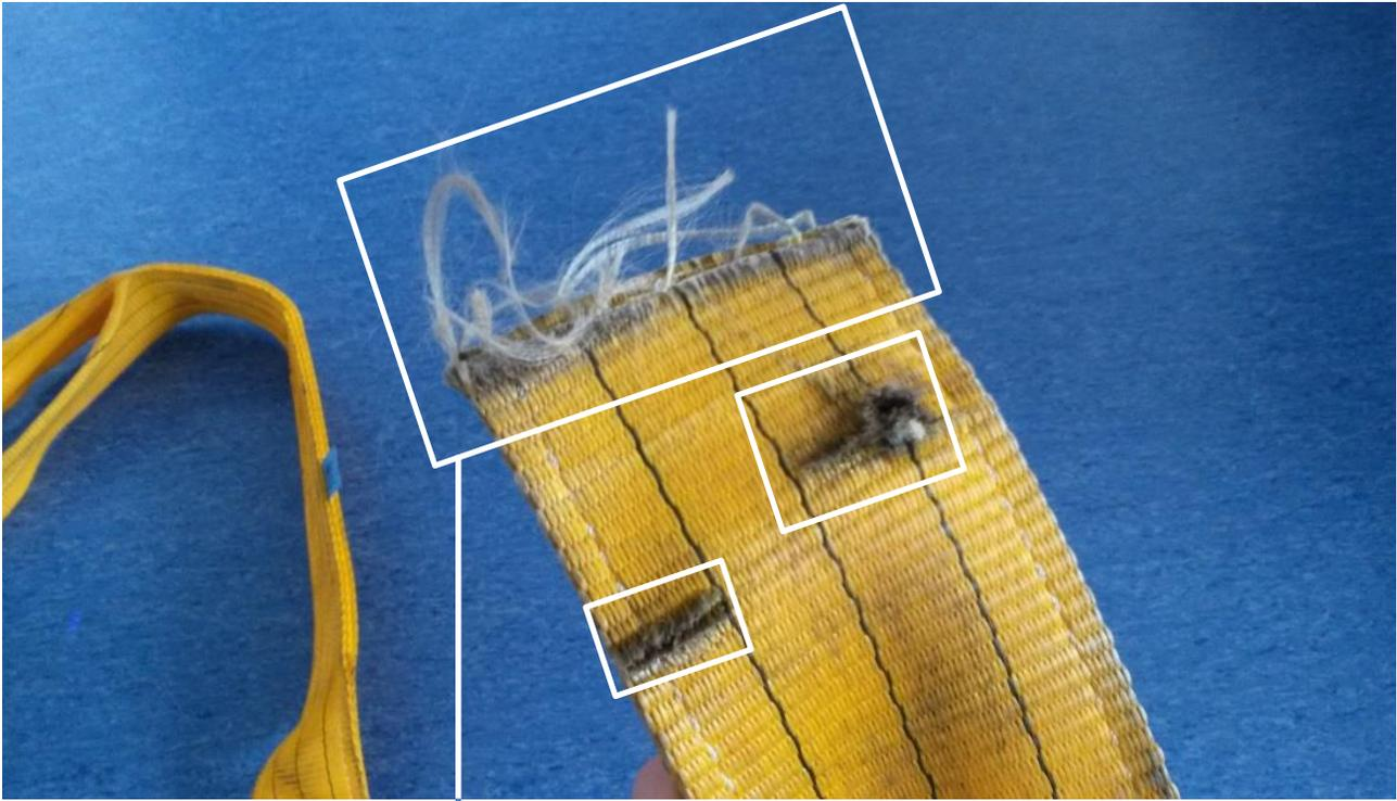
Beschädigtes Sicherheitshebeband durch ein scharfkantiges Stahlblech welches durch eine Brennschneid-Kante besonders schnell zerschnitten wurde. Weitere Beschädigungen des Hebebands sind ersichtlich.
