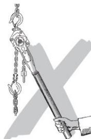
Das Gerät darf niemals mit mehr als der Kraft einer Person bedient werden. Schweißarbeiten an Haken und Lastkette sind verboten. Die Lastkette darf nicht als Erdungsleitung bei Schweißarbeiten verwendet werden. Schrägzug, d.h. seitliche Belastungen des Gehäuses oder der Unterflasche, ist verboten.
