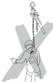
Lastkette nicht knoten oder mit Bolzen, Schraube, Schraubendreher oder Ähnlichem verbinden. Fest in Hebezeugen eingebaute Lastketten dürfen nicht instand gesetzt werden.
