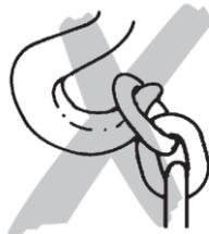
Das Kettenendstück darf nicht als betriebsmäßige Hubbegrenzung verwendet werden. Ein betriebsmäßiges Drehen der aufgenommenen Lasten ist verboten, da die Unterflasche des Gerätes dafür nicht konzipiert ist. Ist ein betriebsmäßiges Drehen vorgesehen, müssen sog. Drallfänger eingesetzt werden bzw. es ist mit dem Hersteller Rücksprache zu halten.
