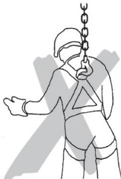
Lastkette nicht knoten oder mit Bolzen, Schraube, Schraubendreher oder Ähnlichem verbinden. Fest in Hebezeugen eingebaute Lastketten dürfen nicht instand gesetzt werden.
